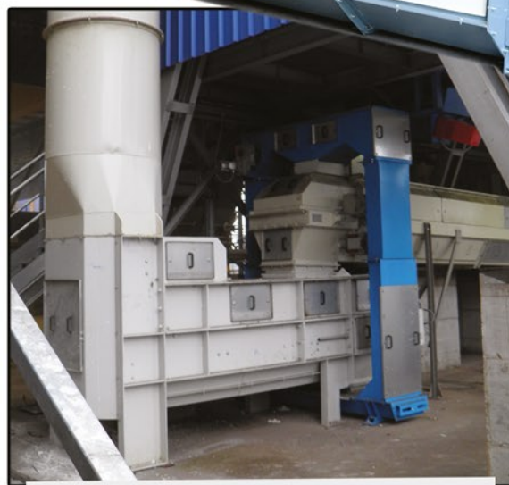
PULITORE ELEVATORE ad "O" con recupero da un trasportatore piano ed un elevatore "O" elevating cleaner collecting from a linear and an elevating conveyor
