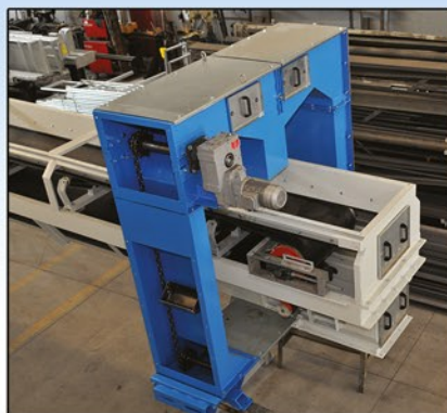
PULITORE ELEVATORE ad "O": a sx aperto. a dx con portelli montati "O" Elevating cleaner – open (left), closed (right)
