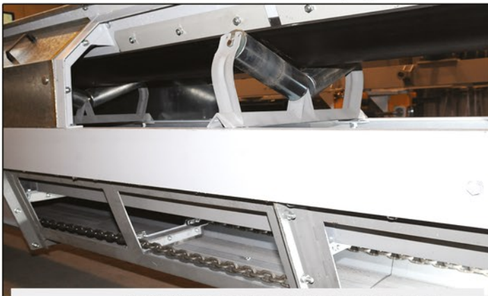
PULITORE a catene con traversine (sotto) Chain cleaner with cross bars (bottom)
