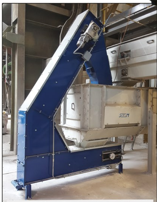
PULITORE ELEVATORE ad "L" per installazione di coda o trasversale "L" Elevating cleaner
