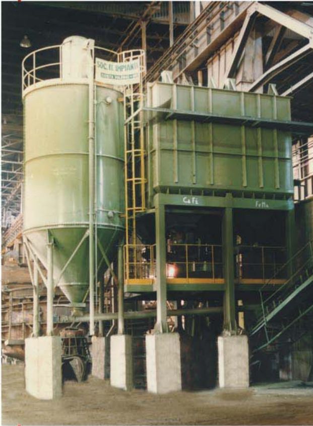
Silo per calce e tramogge per additivi per forno elettrico ad arco
